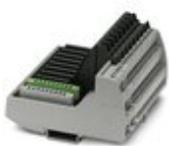
Цокольный модуль VIP с принадлежностями ввода/вывода (IOA) обеспечивает универсальное конфигурирование каналов. Этот модуль имеет маркировки для каналов 25–32, а также конформное покрытие оснащения печатных плат.
