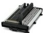
Цокольный модуль VIP с принадлежностями ввода/вывода (IOA) обеспечивает универсальное конфигурирование каналов. Благодаря штекерному соединителю D-SUB 50 данный модуль совместим с выводами устройств серии Tricon CX DCS.
