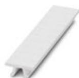
Планка Zack, Полоса, белый, без надписи, маркируется с помощью: PLOTMARK, CMS-P1-PLOTTER, тип монтажа: крепление в высоких пазах для табличек, для клемм шириной: 5,08 мм, размер маркировочного поля: 4,98 x 10,5 мм, Количество отдельных табличек: 10
