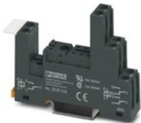
Релейный блок ECOR-1..., для миниатюрных силовых реле или миниатюрных реле с 1 или 2 переключателями контактами, винтовой зажим, возможность установки входных модулей/модулей подавления помех, для монтажа на NS 35/7,5
