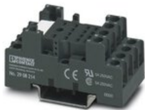
Релейный блок ECOR-2, для промышленных реле с 4 переключающими контактами, болтовое соединение, для монтажа на NS 35/7,5
