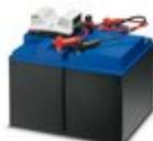
Энергоаккумулятор, литий-ионная технология, 24 В DC, 924 Вт-ч, для окружающей температуры от -25 °C ... 60 °C, автоматическое распознавание и передача данных с помощью QUINT UPS-IQ
