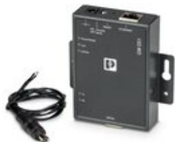
Приборный сервер с последовательной передачей для преобразования последовательных данных (RS-232/422/485) в данные Ethernet (RJ45). С поддержкой протоколов TCP и UDP в дополнение к Modbus/RTU (или ASCII) и Modbus/TCP. Программное обеспечение COM Port Redirector доступно для скачивания. Включает один разъем RJ45 и один разъем D-SUB-9.
