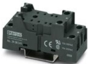
Релейный блок ECOR-2, для промышленных реле с 2 переключающими контактами, болтовое соединение, для монтажа на NS 35/7,5
