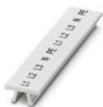
Планка Zack, Полоса, белый, с маркировкой, горизонтально: L1, L2, L3, N, PE, L1, L2, L3, N, PE, тип монтажа: крепление в высоких пазах для табличек, для клемм шириной: 5,2 мм, размер маркировочного поля: 5,15 x 10,5 мм, Количество отдельных табличек: 10
