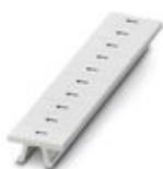
Планка Zack, Полоса, белый, с маркировкой, маркируется с помощью: CMS-P1-PLOTTER, надписи вдоль: одинаковые номера 1 или 2 и т.д. до 100, тип монтажа: крепление в высоких пазах для табличек, для клемм шириной: 5,2 мм, размер маркировочного поля: 5,15 x 10,5 мм, Количество отдельных табличек: 10
