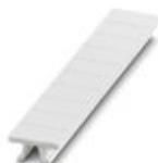
Планка Zack, Полоса, белый, без надписи, маркируется с помощью: PLOTMARK, CMS-P1-PLOTTER, тип монтажа: вставлять, для клемм шириной: 5,2 мм, размер маркировочного поля: 5,1 x 10,5 мм, Количество отдельных табличек: 10
