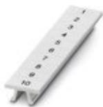
Планка Zack, белый, надписи поперек: нумерация по порядку 1 ...10, 11 ...20 и т.д. до 491 ...500, тип монтажа: крепление в высоких пазах для табличек, для клемм шириной: 5,2 мм, размер маркировочного поля: 5,15 x 10,5 мм
